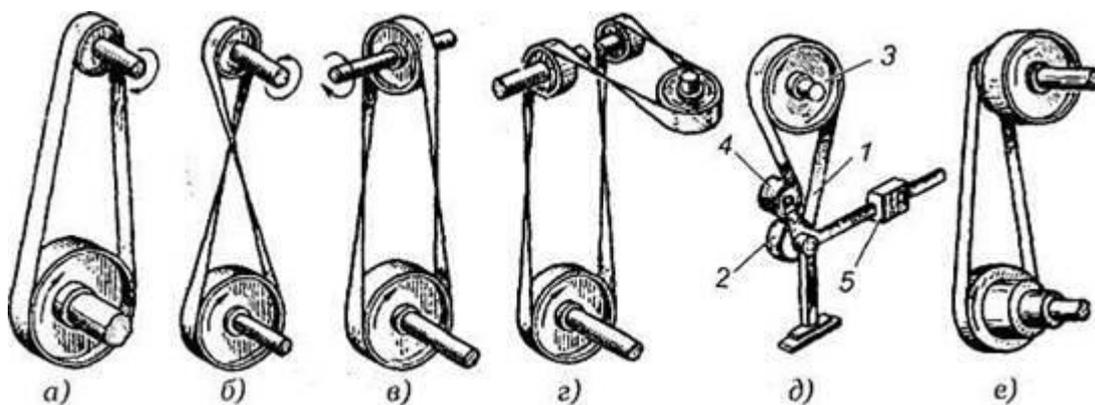
Виды ременных передач: *а* — открытая передача; *б* — перекрестная передача; *в* — полуперекрестная передача; *г* — угловая передача (с направляющим роликом);
